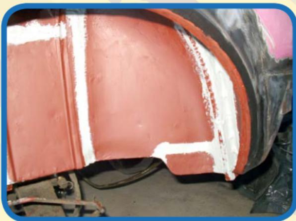
Nach Trocknung der Dichtmasse (ca. 12 bis 24 Stunden, oder auch später) erfolgt das Auftragen der Endbeschichtung. Mit einem Trocknungsabstand von jeweils ca. 24 Stunden wurden drei
