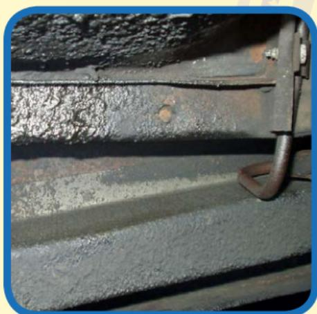
Teilweise war dieses Auto mit einem Bitumenunterbodenschutz versehen, bei dessen Auftragen aber nicht sehr gründlich vorgegangen worden ist. In den Ecken und Winkeln, teilweise auch auf kompletten Trägern oder neu eingeschweißten Bodenblechen ist nur grundiertes oder lackiertes Blech vorhanden. In diesen Bereichen ist zum Teil auch Oberflächenrost des ksd®-Rostgrades 1-2 zu finden.
