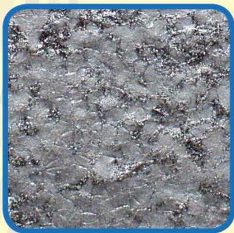
Teilweise findet man auch Unterböden vor, die so gut wie keinen Steinschlagschutz aufweisen und nur lackiert sind, bzw. waren. Dies ist relativ typisch für Importfahrzeuge aus südlichen Ländern oder den USA, aber auch neuere Fahrzeuge ab ca. Bj. 1995 sind teilweise nur sehr sparsam mit Unterboden- bzw. Steinschlagschutz versehen.
