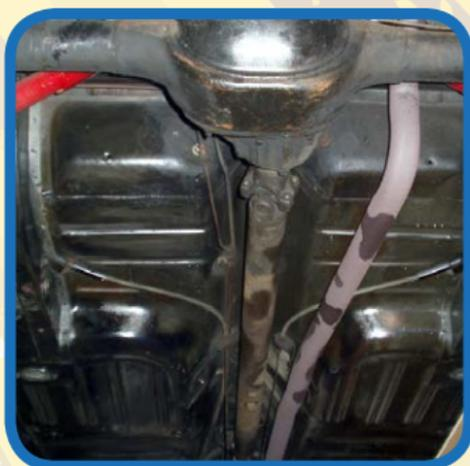
Wenn im Gegensatz zum hier gezeigten Fall der Unterbodenschutz noch vollflächig vorhanden ist besteht nicht unbedingt die Notwendigkeit nach dem Sättigen mit Owatrol Öl noch weitere Schutzschichten aufzutragen. Ein Eindringen von Wasser ist zuverlässig ausgeschlossen, der Schutzanstrich wird wieder etwas elastischer und somit an der weiteren Alterung gehindert. Etwa alle 2 Jahre auf diese Weise aufgefrischt hält so ein Unterbodenschutz auch im Alltagsbetrieb noch lange Zeit sehr zuverlässig.
