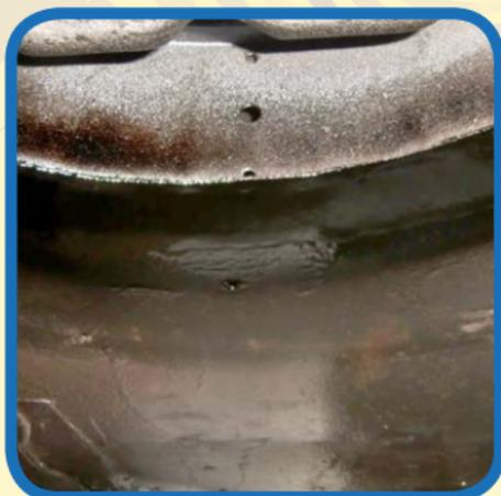
Zusätzlich wurde der restliche Unterboden noch komplett mit Owatrol Öl eingesprüht um auch die alte Beschichtung aufzufrischen und witterungsfest zu versiegeln. Daher rührt der etwas ungewöhnliche Glanz auf der restlichen Unterbodenfläche. Alternativ eignet sich hierzu auch Oxyblock.
